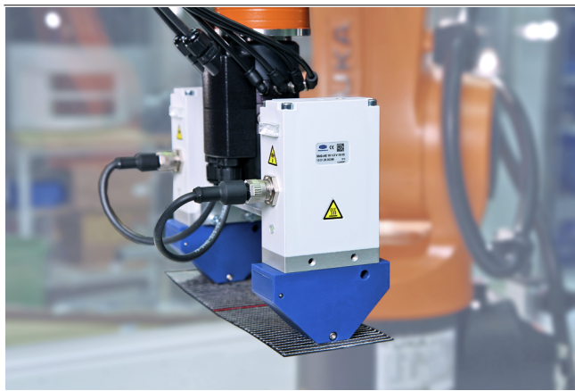
Pinze di presa ad aghi SNGi-AE per la movimentazione di materiale composito
